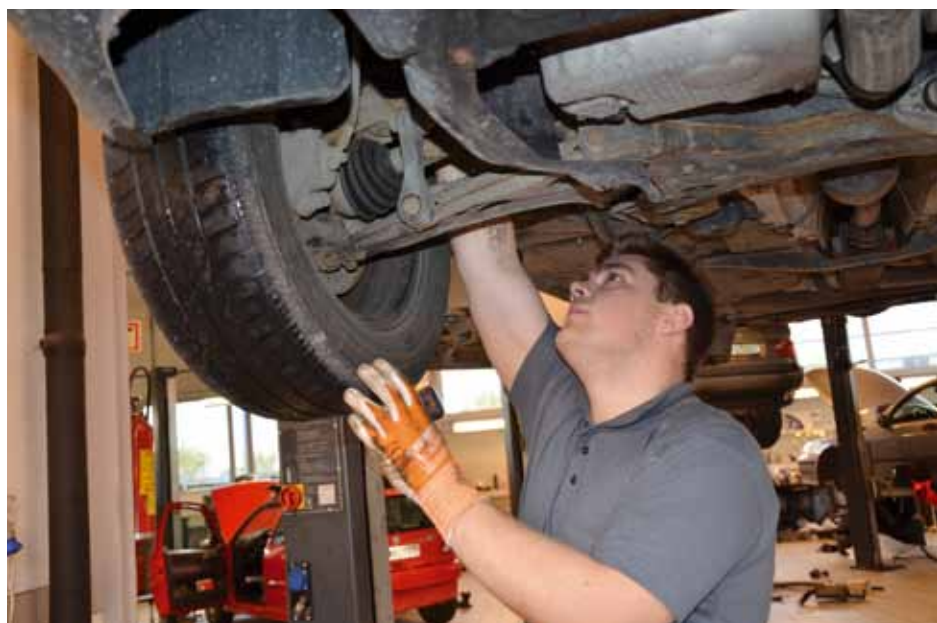
Marius Brændshøi forbereder støtdemperskifte på en VW Golf.
